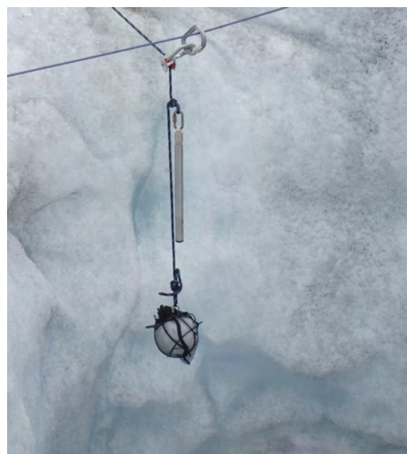
写真：Cryoegg をロープに括ってムーリンに降ろす様子
