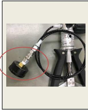
②検査対象の圧力計をクイックコネクタに取り付けます
