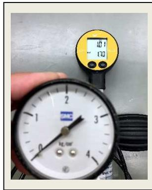
⑤基準用圧力計と検査対象の指示値を比較し合否判定します
